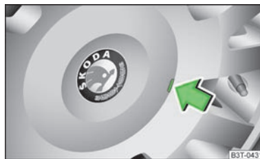
Илл. 154 Отсоединить крышку болтов легкосплавных дисков
