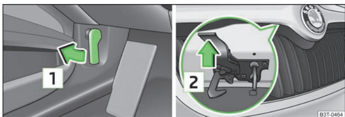
Илл. 141 Стопорный рычаг капота / решетка радиатора: стопорный рычаг
