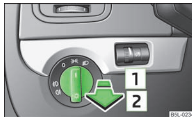
Илл. 25 Передняя панель: переключатель освещения
