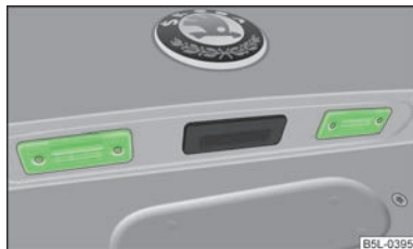
Илл. 175 Крышка багажного отделения: фонарь подсветки номерного знака.
