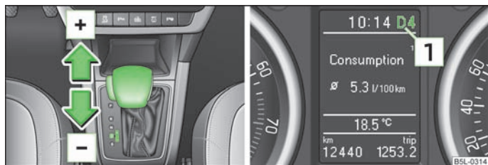
Илл. 107 Рычаг селектора / информационный дисплей: положения рычага селектора
