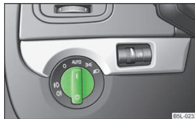
Илл. 24 Передняя панель: переключатель освещения
