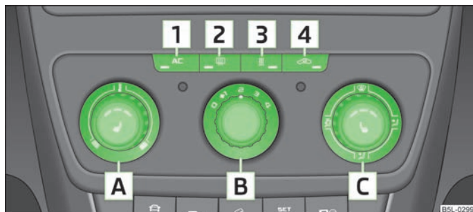
Илл. 89 Климатическая установка: Панель управления
