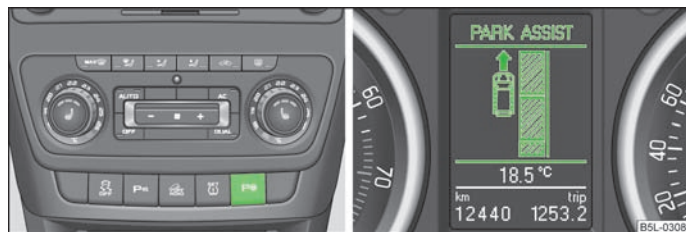
Илл. 101 Включение индикации парковочного автопилота на информационном дисплее / информационный дисплей: Поиск подходящего парковочного места
