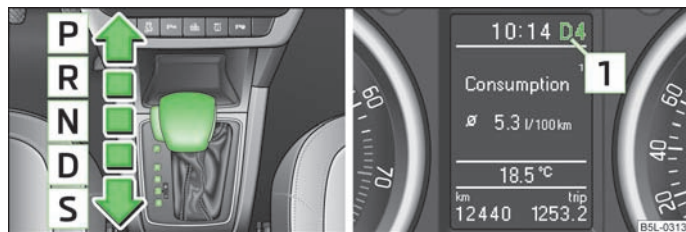
Илл. 106 Рычаг селектора / информационный дисплей: положения рычага селектора
