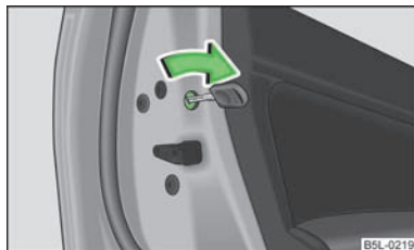
Илл. 10 Блокировка от случайного открывания задних дверей изнутри
