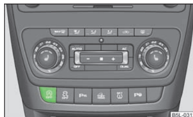
Илл. 105 Клавиша управления системой Старт-стоп.
