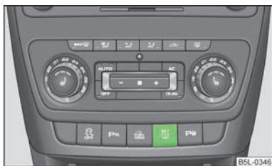
Илл. 155 Кнопка установки контрольных значений давления в шинах
