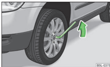
Илл. 158 Замена колеса: откручивание колёсных болтов
