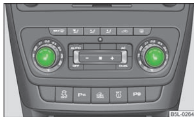
Илл. 45 Передняя панель: Регулятор подогрева передних сидений
