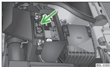
Илл. 149 АКБ: индикация уровня электролита
